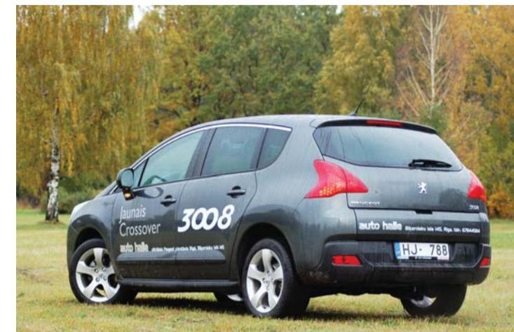
garenbāze – 2616 mm, klirens – 149 mm. Pēc izmēriem "lauvēns" tikai par 58 mm atpaliek no *VW Tiguan* garumā, bet pārspēj to platumā par 20 mm un augstumā par 6 mm.
